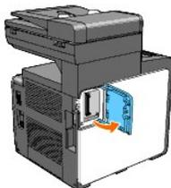
6. Orientare il connettore della scheda di memoria verso l'alloggiamento e inserire la scheda di memoria nell'alloggiamento.
