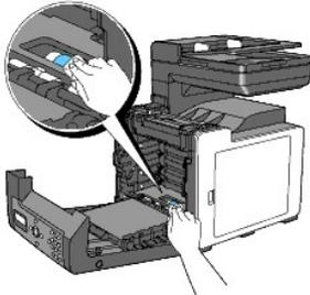
6. Inserire l'unità PHD fino all'arresto e ruotare le quattro leve di blocco PHD in senso orario per bloccare l'unità PHD.
